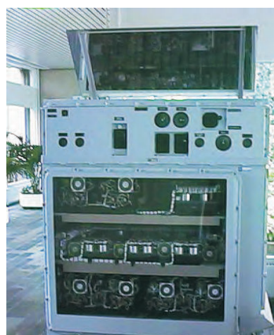
Elektromechanisch vuurleidingstoestel ("rekenaar") Fabrikaat N.V. Hollandse Signaalapparaten, 1952-1960
